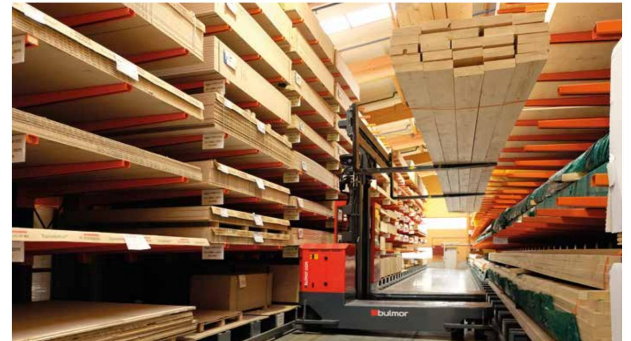
**Sparen von Lagerfläche durch Spurführungssysteme**
